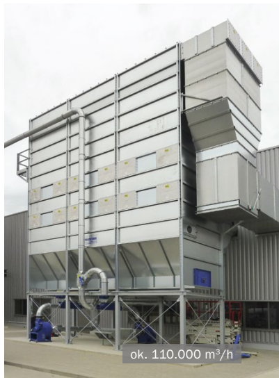
Filtr MultiStar z przedmuchami rewersyjnym powietrzem
