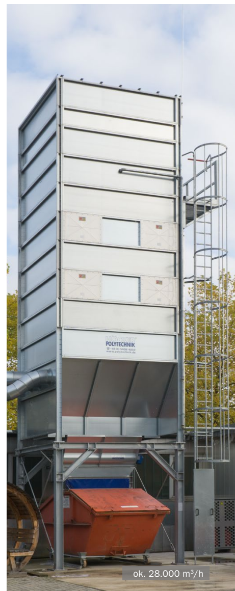
Filtr MultiStar ze śluzą, wysyp do kontenera • Szkoła zawodowa
