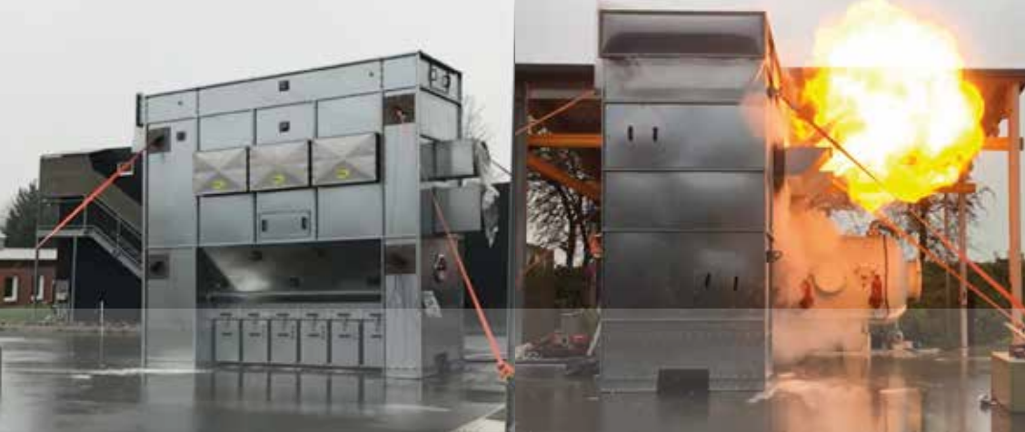
Test wybuchu przy ciśnieniu 220 mbar
