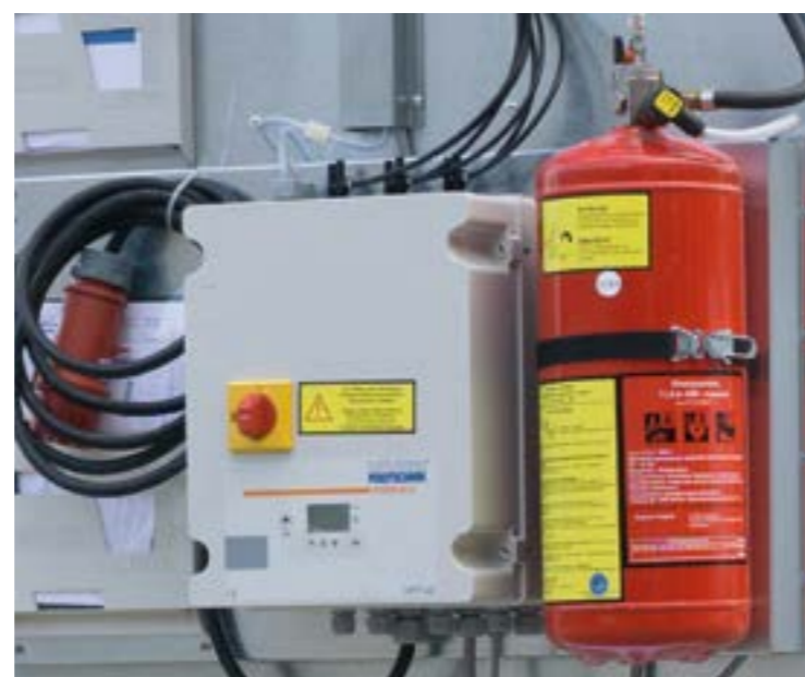
Ilustracja dolna: Sterowanie SPS, seryjnie z automatyką włączeniową maszyny oraz, Wbudowana automatyczna proszkowa instalacja gaśnicza
