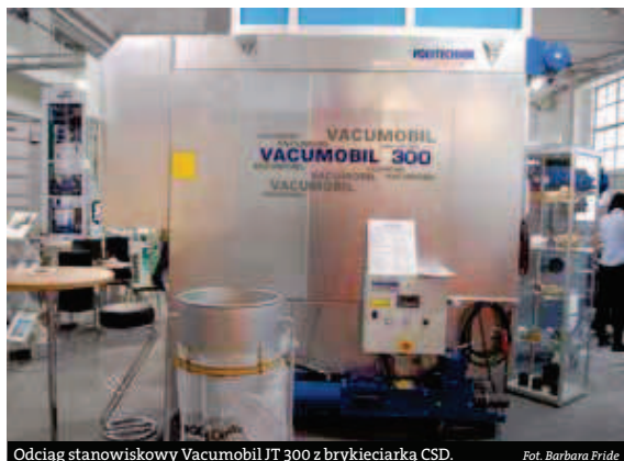
Odciąg stanowiskowy Vacumobil JT 300 z brykietarką CSD.
