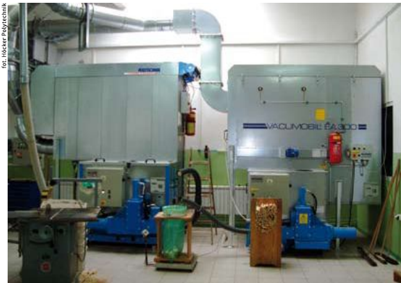
W przypadku zestawu odciąg – brykieciarka ta ostatnia zamontowana jest w jego dolnej części.
