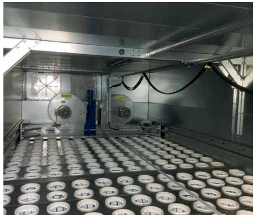
Rękawy filtracyjne są oszczędnie, ale skutecznie, regenerowane za pomocą techniki oczyszczania przedmuchami rewersyjnym powietrzem. Dzięki temu stopień zanieczyszczenia worków filtracyjnych utrzymuje się na niskim poziomie, a wydajność wentylatorów - na wysokim.
