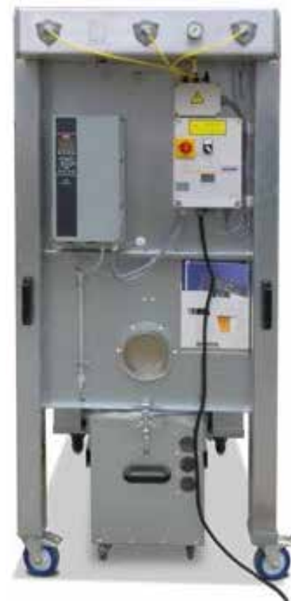
Odpylacz zapewnia stuprocentowe wykorzystanie energii cieplnej poprzez powrót powietrza. HÖCKER POLYTECHNIK
